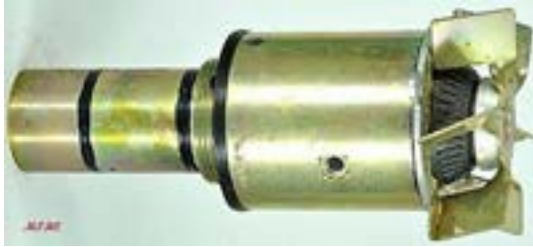
LAS ESPOLETAS KAPPA-III SON MECÁNICAS; LA ACCIÓN DE LA HÉLICE PERMITE EL ARMADO DE LA BOMBA, Y EL ARMADO SE PRODUCE EN 3 S
