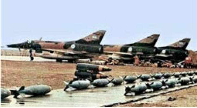
CORREDOR DE BOMBAS BRP-250 KG (EXPAL) DE COLA LISA (IZQUIERDA) Y DE COLA FRENADA POR PARACAÍDAS (DERECHA), JUNTO A LOS CAZAS POLIVALENTES MV-DAGGER
