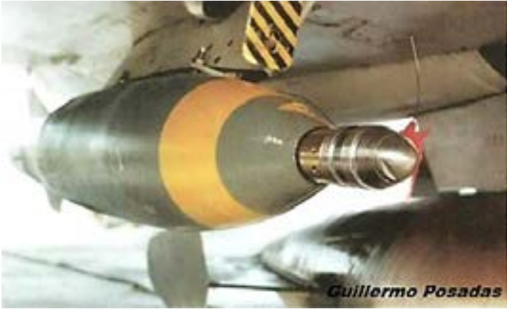
BOMBA EXPAL (EXPLOSIVOS ALAVESES) BRP-250 KG, CON ESPOLETA KAPPA-E (ELECTRÓNICA) Y UN TIEMPO DE ARMADO DE UNOS 2,6S
