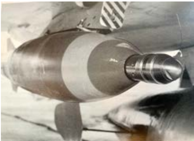
ESPOLETA KAPPA-E (ELECTRÓNICA) EN UNA BOMBA BR-250 KG
