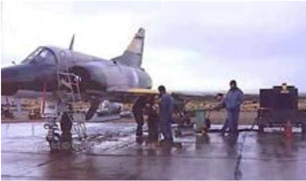
PERSONAL DE MANTENIMIENTO CAMBIA LA CONFIGURACIÓN EN UNO DE LOS DAGGER
