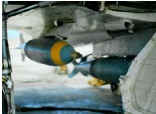
BOMBA RETARDADA POR PARACAÍDAS EXPLOSIVOS ALAVESES DE 250 KG, CON ESPOLETA SSQ EN EL SOPORTE VENTRAL DE UN DAGGER
