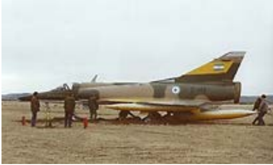
PERSONAL DE MANTENIMIENTO TRABAJA PARA RECUPERAR EL DAGGER C-411 QUE DESPISTÓ LUEGO DE SU ATERRIZAJE
