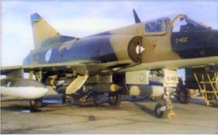
MV-DAGGER, LISTO PARA COMBATIR, ARMADO CON BOMBAS FRENADAS BRP-250 KG
