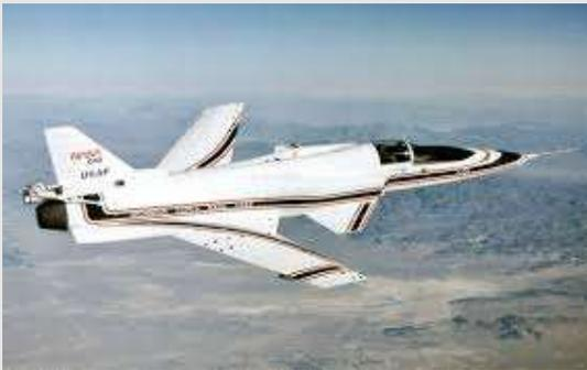
El Grumman X-29, desarrollado por la NASA y la Fuerza Aérea de EE. UU., voló por primera vez en 1984 y destacó por su diseño innovador de alas con flecha negativa, lo que le otorgaba gran maniobrabilidad y menor resistencia aerodinámica, aunque con alta inestabilidad. Esta fue compensada mediante controles de vuelo digitales que realizaban hasta 40 correcciones por segundo. Concebido como banco de
