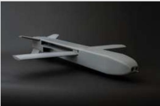
La empresa checa LPP s.r.o. presentó el interceptor contra UAV JWI-4000, diseñado para neutralizar drones kamikaze como el Shahed-136. Cuenta con ala fija plegable para despegue vertical, opción de impulso cohete y un propulsor eléctrico en conducto que alcanza 300 km/h, opera hasta 4.000 m y vuela unos 20 minutos a altura operativa. Equipa sensores avanzados, IA para apuntamiento autónomo y una ojiva de fragmentación direccional de hasta 1,5 kg.
