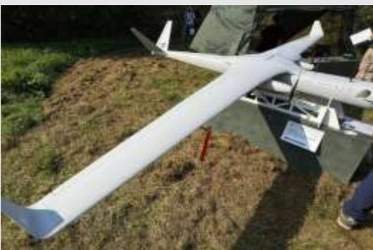
Desarrolladores rusos presentaron el dron RD-8, controlable mediante terminales Starlink o redes m viles pese a la prohibici n del servicio en Rusia. Fabricado por Valkyrie Design Bureau, el RD-8 es una plataforma h brida de 3,8 m de envergadura, 35 kg MTOW, 4,5 horas de vuelo y 150 km de alcance, capaz de portar y lanzar dos FPV con ojivas de 3 kg. Existen variantes mayores (RD-12) con hasta 20 horas y 800 km. Terminales Starlink se obtienen en un
