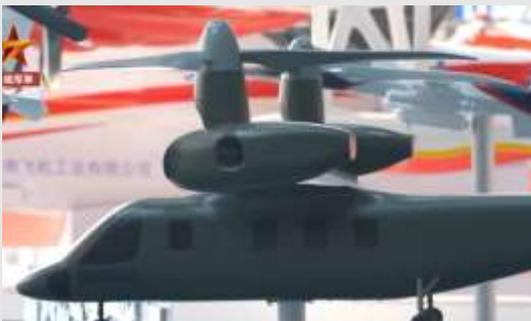
China ha avanzado en su programa de avión tiltrotor, exhibido previamente en exposiciones como Zhuhai Airshow 2022 y AERO Asia 2023. El prototipo permite despegue y aterrizaje vertical, combinando la flexibilidad de un helicóptero con velocidades superiores a 600 km/h, triplicando la eficiencia de transporte frente a helicópteros convencionales. A diferencia del V-22 Osprey estadounidense, solo los rotores
