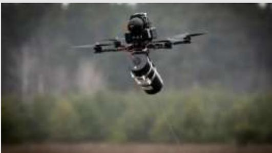
En Ucrania emergen drones controlados por fibra óptica, que no dependen del espectro electromagnético, lo que los hace inmunes a interferencias, spoofing GPS y detección electrónica. Este avance desafía décadas de inversión en guerra electrónica. Sus limitaciones actuales son el peso y la longitud del cable, aunque el desarrollo de fibras ultraligeras promete ampliar su alcance.
