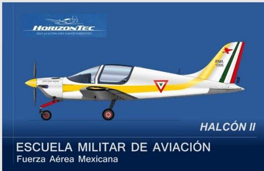
Horizontec, empresa de Guanajuato, desarrolló en Celaya el Halcón 2, primer avión diseñado y fabricado en ese estado. Clasificado como LSA (Light Sport Aircraft), está destinado al entrenamiento, vuelo recreativo y vigilancia. Fabricado con materiales compuestos y motor Rotax 915is, tiene una autonomía de hasta 6 horas. En FAMEX 2025 se presentó el Halcón 2.1, con mejoras estructurales y mayor capacidad de combustible. Actualmente en fase
