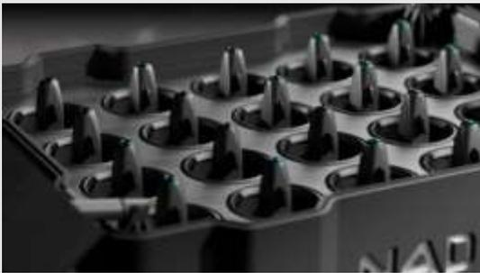
La startup sueca Nordic Air Defence ha desarrollado el Kreuger 100, una plataforma de drones miniatura diseñados para interceptar UAVs como los Orlan-10 y Shahed-136. Lanzados manualmente o desde sistemas portátiles, estos interceptores alcanzan hasta 270 km/h y utilizan propulsión pulsada y algoritmos de control aerodinámico para eliminar componentes costosos. Su arquitectura
