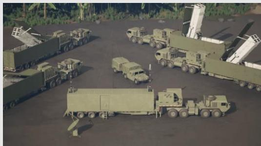
El Sistema Estratégico de Incendios de Medio (SMRF) "Typhon" es un arma de ataque terrestre de EE.UU. que integra los misiles Tomahawk y SM-6, mejorando su capacidad ofensiva de mediano alcance. Montado en una plataforma móvil HEMTT, ofrece flexibilidad y despliegue rápido. Su desarrollo responde a la creciente competencia en el Indo-Pacífico,
