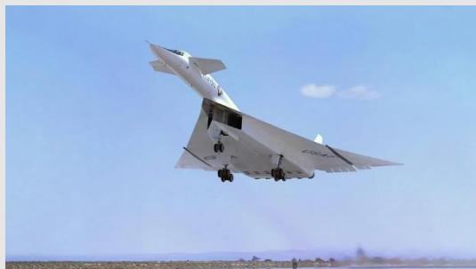
El XB-70 Valkyrie fue un bombardero supersónico desarrollado por EE.UU. durante la Guerra Fría para alcanzar Mach 3 y 70,000 pies de altitud, con capacidad nuclear. Diseñado por North American Aviation, combinaba tecnologías avanzadas como alas móviles y materiales resistentes al calor. Sin embargo, la aparición de misiles tierra-aire y los ICBM redujo su relevancia táctica.
