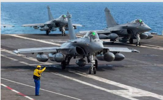
El Rafale M, versión naval del Dassault Rafale, está diseñado para operar desde portaaviones con estructura reforzada, tren de aterrizaje robusto y gancho de apontaje. Impulsado por dos motores SNECMA M88-2, alcanza Mach 1.8 y opera a 50,000 pies, con un alcance de 1,000 millas náuticas. Su arsenal incluye misiles MICA, Exocet y el nuclear ASMP-A. Equipa radar AESA y sistema SPECTRA de guerra electrónica. Ha
