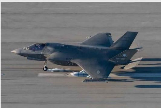
El F-35B de Lockheed Martin realizó su primer vuelo transportando el misil antibuque AGM-158B LRASM, como parte de la actualización del Bloque 4 del F-35. Esta integración permite llevar misiles JASSM/LRASM externamente, ampliando su alcance y efectividad en misiones polivalentes. La prueba se realizó en Patuxent River, Maryland, con un misil bajo cada ala. En septiembre, el F-35C también fue equipado con LRASM. Este misil furtivo,
