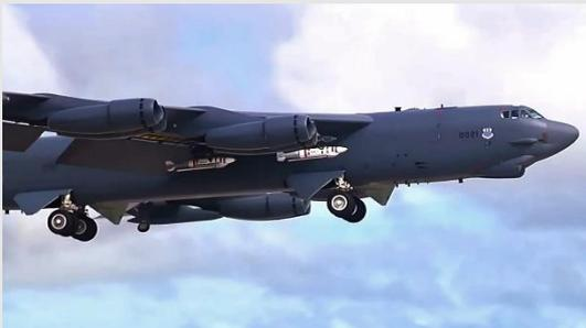
El Quickstrike-Extended Range (QS-ER) es un avance en la guerra de minas navales, combinando las minas Quickstrike con la tecnología JDAM. Gracias a su guía GPS y alas, puede deslizarse hasta 40 millas náuticas, permitiendo el despliegue desde bombarderos B-52 sin poner en riesgo a las tripulaciones. Su integración en el arsenal estadounidense mejora la defensa costera y
