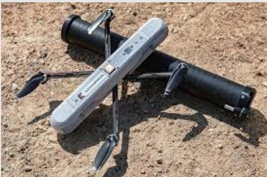
En IDEX 2025, Kalashnikov presentó su microdron Karakurt-R, un mini-UAV VTOL ultracompacto diseñado para operaciones tácticas rápidas y en espacios confinados. Con un peso de 300-400 gramos, puede ser transportado en el bolsillo de un soldado y lanzado en segundos desde un contenedor tipo tubo. Este dron tiene una velocidad máxima de 25 km/h, autonomía de 20-25 minutos, y alcance de hasta 2 km. Equipado con sensores diurnos y nocturnos, permite
