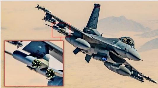
Nuevas imágenes muestran a los F-16C Viper de la Fuerza Aérea de EE. UU. patrullando el Medio Oriente con una innovadora configuración: dos cápsulas de cohetes APKWS II de 70 mm en un mismo pílón, combinadas con misiles aire-aire AIM-120 y AIM-9 Sidewinder. Estas municiones, diseñadas inicialmente para ataques aire-tierra, se utilizan como una solución de bajo
