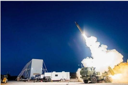
El PrSM (Precision Strike Missile) es el misil de próxima generación del Ejército de EE. UU., diseñado para reemplazar el ATACMS. Con un rango superior a 500 km, es lanzado desde sistemas como HIMARS y MLRS, llevando dos misiles por cápsula. Su guía GPS y ojiva de fragmentación lo hacen adecuado para atacar objetivos de alto valor. Desarrollado por Lockheed Martin, el PrSM ha superado exitosas pruebas y se espera que en versiones futuras pueda atacar
