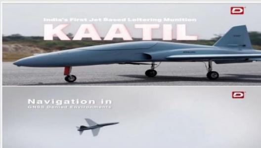
Dynauton Systems, división de Dynamic Technologies Limited, presentará en Aero India 2025 la munición vagabunda *Kaatil*, desarrollada a nivel indígena. Con un peso de 12 kg y una carga útil de 1 kg, *Kaatil* tiene un diseño con tren de aterrizaje que le permite despegar como un UAV estándar, mejorando su versatilidad y capacidad de reutilización. Impulsado por propulsión a chorro, alcanza hasta 600 km/h, superando
