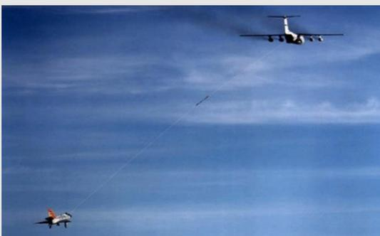
El proyecto Eclipse, apoyado por la NASA y la Fuerza Aérea de EE. UU., demostró un concepto de vehículo de lanzamiento de remolque reutilizable. Utilizando un QF-106 como demostrador (EXD-01) y un C-141A como avión remolcador, se realizaron pruebas de remolque, rodaje y vuelos. El objetivo principal, demostrar el despegue, ascenso y separación del EXD-01, se alcanzó exitosamente con seis vuelos
