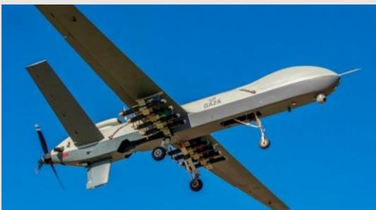
El Shahed-149 "Gaza" es un UCAV iraní de gran altitud y larga resistencia, similar al MQ-9 Reaper, con 21 m de envergadura y 3.100 kg de peso. Puede volar 35 horas con un radio de combate de 2000 km. Equipado con misiles guiados Sadid-345, ofrece precisión en ataques con un CEP de hasta 2,5 m. Su presentación en 2021 simbolizó el apoyo iraní a Palestina y su capacidad militar
