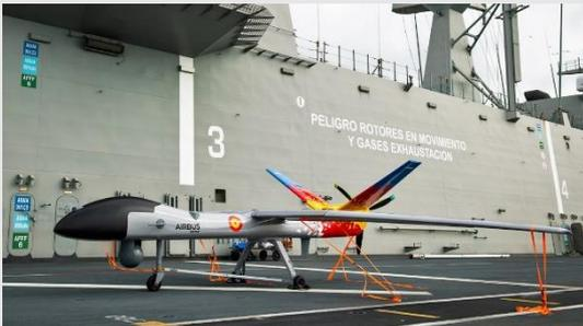
España está explorando la integración de drones en su único portaaviones, el *Juan Carlos I*, para reemplazar sus aviones de ataque EAV-8B Matador II. Airbus y Navantia firmaron un acuerdo para integrar el dron SIRTAP, diseñado para vigilancia con carga útil electroóptica y radar. El dron tiene una autonomía de más de 20 horas y se integrará en el sistema de gestión de combates
