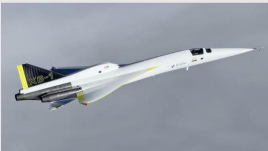
El XB-1 de Boom Supersonic ha roto la barrera del sonido, logrando un hito importante en su desarrollo hacia el avión supersónico Overture. Durante su vuelo, alcanzó Mach 1.1 en el corredor aéreo histórico del Bell X-1. El XB-1, un demostrador a escala, utiliza tres motores turbojets General Electric J85-15 y busca alcanzar Mach 2.2. Overture, el avión
