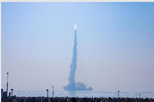
China lanzó el cohete Smart Dragon 3 desde una nave en Haiyang, Shandong, logrando colocar 10 satélites en órbita terrestre baja a 650 km de altitud. Este es el quinto lanzamiento del modelo, que mide 31 metros de altura, pesa 140 toneladas al despegue y es impulsado por un motor de propulsión sólida con 200 toneladas de empuje. Capaz de transportar 1,5 toneladas a órbitas solares sincrónicas, el cohete realizó su primer vuelo en 2022 y ha completado cuatro misiones
