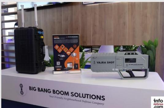
La empresa india Big Bang Boom Solutions (BBBS) presentó su sistema antidrón Vajra Sentinel en Exponaval 2024, destacando sus innovaciones en defensa aérea. El Vajra Sentinel incluye detectores y bloqueadores de drones, como el portátil Vajra Shot, capaz de inutilizar drones mediante señales de radiofrecuencia que interrumpen el control, el GPS y las transmisiones de video. Con un alcance de 2 km y un peso de 3,5 kg, este dispositivo puede actualizarse al modelo
