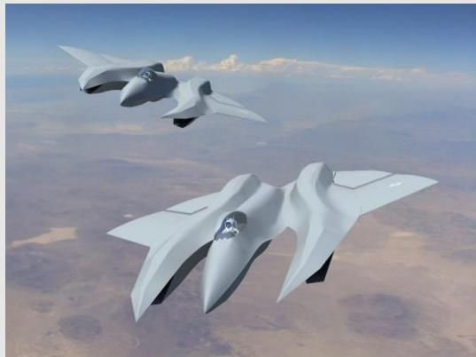
Stavatti Aerospace propuso el SM-39 Razor como alternativa para el programa NCAD de la Marina de EE. UU., destinado a reemplazar al F/A-18E/F en la década de 2030. El concepto presenta un diseño de triple fuselaje furtivo, capaz de alcanzar Mach 4 y supercruce superior a Mach 2,5. Incorporaría armas de energía dirigida, aviónica avanzada con radar AESA y tres versiones: tripulada, biplaza y autónoma. El plan prevé 600 aviones, entregas entre 2031 y 2037 y una nueva planta industrial en EE.UU.
