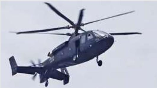
China ha revelado imágenes de un helicóptero coaxial compuesto en pruebas de vuelo, con un diseño muy similar al Sikorsky S-97 Raider estadounidense. El aparato, aún sin designación oficial, emplea rotores coaxiales rígidos y hélice propulsora, lo que le otorga mayor velocidad, maniobrabilidad y alcance que un helicóptero convencional. Este desarrollo llega apenas días después
