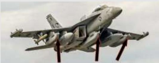
Un RAT (Ram Air Turbine) es un sistema de emergencia que proporciona energía eléctrica e hidráulica a aeronaves cuando fallan los motores o sistemas principales, funcionando solo con el flujo de aire. Se despliega automáticamente o manualmente y permanece oculto para evitar arrastre. En
