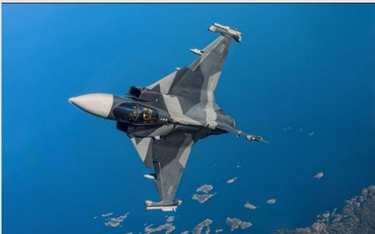
El Gripen E y el F-16V Block 70/72 compiten como cazas ligeros OTAN de generación 4.5 para países con presupuestos limitados. El Gripen destaca por su bajo costo operativo, mantenimiento sencillo y capacidades como el radar AESA Raven y el misil Meteor. El F-16V ofrece mayor potencia, carga útil y experiencia en combate, pero con un costo por hora de vuelo más alto. Ambos son interoperables con armamento OTAN, pero
