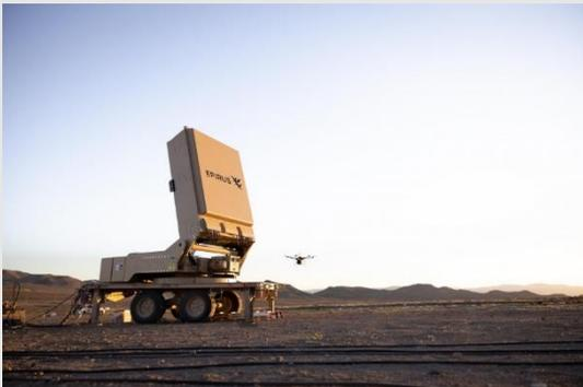
El sistema Leonidas H20, desarrollado por la empresa estadounidense Epirus, es una solución de microondas de alta potencia (HPM) diseñada para neutralizar embarcaciones, drones y buques no tripulados. Basado en tecnología de estado sólido y arquitectura abierta, ofrece efectos no cinéticos seguros para personal y material. Durante el ejercicio Coastal Trident de la Armada de EE. UU., logró desactivar motores de hasta 90 caballos de fuerza,
