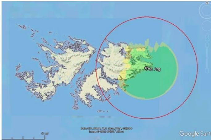
Diagrama de cubrimiento radar para FL 010 (1000 ft) Radar Westinghouse TPS-43 E. Puerto Argentino
