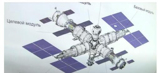
Ilustración 11: variante del complejo ROSS polar con el NEM, el módulo base y otros dos módulos (Roscosmos)
