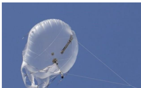
Ilustración 8: globo aerostático Aerobavovna con la carga útil SIGINT de Aero Azmiuth
